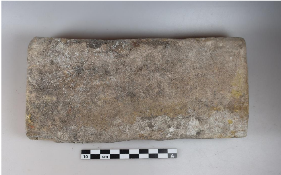
Fig. 16. En noget ujævnt formet teglsten fra teglgulv SS1007, med mål 21,5 x 9,5 x 4 cm. Rester af hvid mørtel er synlig langs med den nedre kant. Foto: nr. 1725 i fotolisten.
