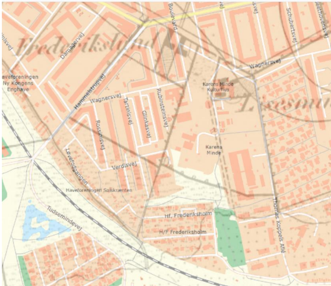
Fig. 3 Kort over Københavns omegn fra 1865, lagt over skærmkort. Matrikulationen ses med mørke streger, og de to udflyttergårde er angivet med navn. Hammelstrupvej løber langs et nu nedlagt dige.
