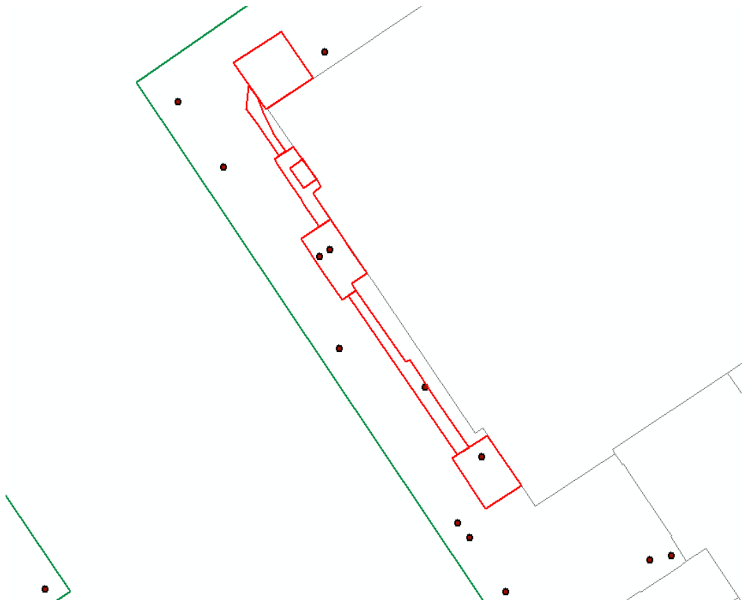
Fig. 14 Oversigt over de gravede arealer (rød linje) og kloakdæksler (mørke prikker). Her kan det ses på forløbet af kloakdæksler til venstre for det gravede areal, at den dybe kloakgrøft fortsætter langs hele facaden og dermed har fjernet lag indtil en dybde af i hvert fald 4 meter.
