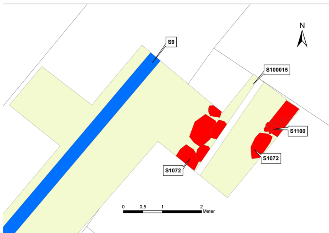
Figur 14. Detalj av undersökningsområdets nordostligaste del, med grundmur (S1072), kullerstensyta (S1100), vattenledningsrör av trä (S9) och modernt vattenledningsrör (S100015). Kartunderlag: fastighetskartan över Köpenhamn år 1689.
