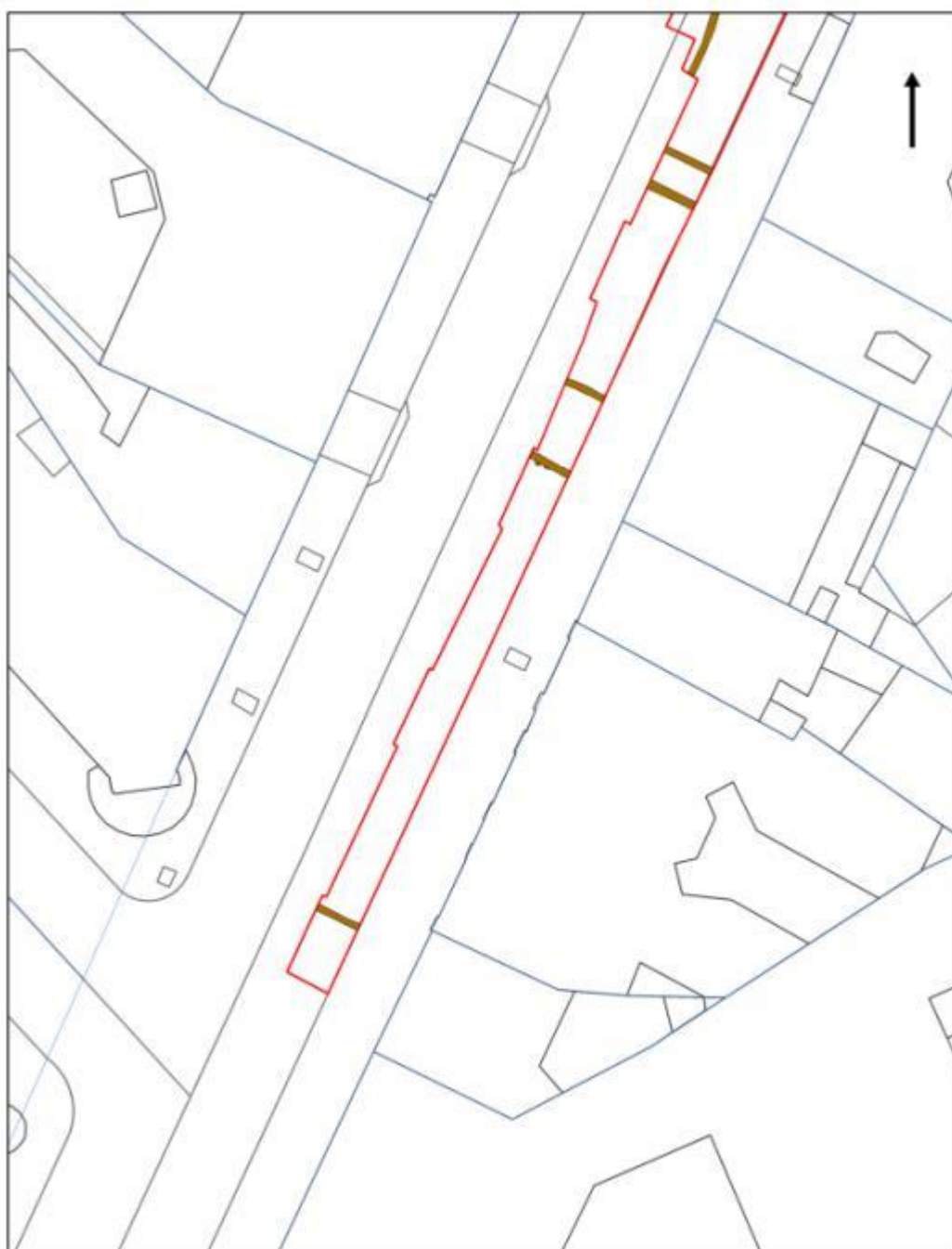
Figur 54. Detail af Vandforsyningsledning 7. De såkaldt "potentielle" stikledninger.
