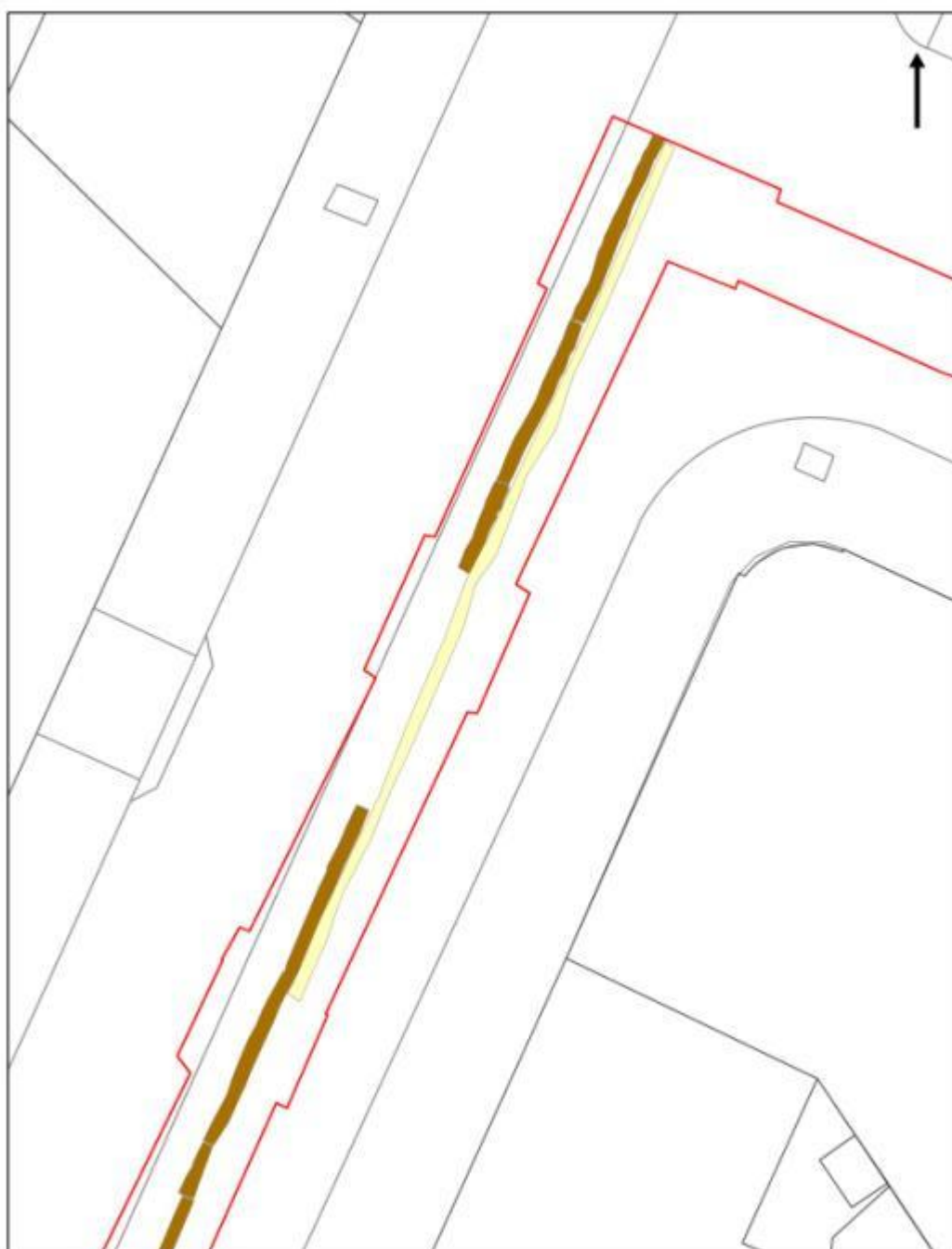
Figur 53. Vandforsyningsnetværk 7. Detail af den observerede nedgravning til forsyningsledningen. Nedgravningen er markeret med gul.
