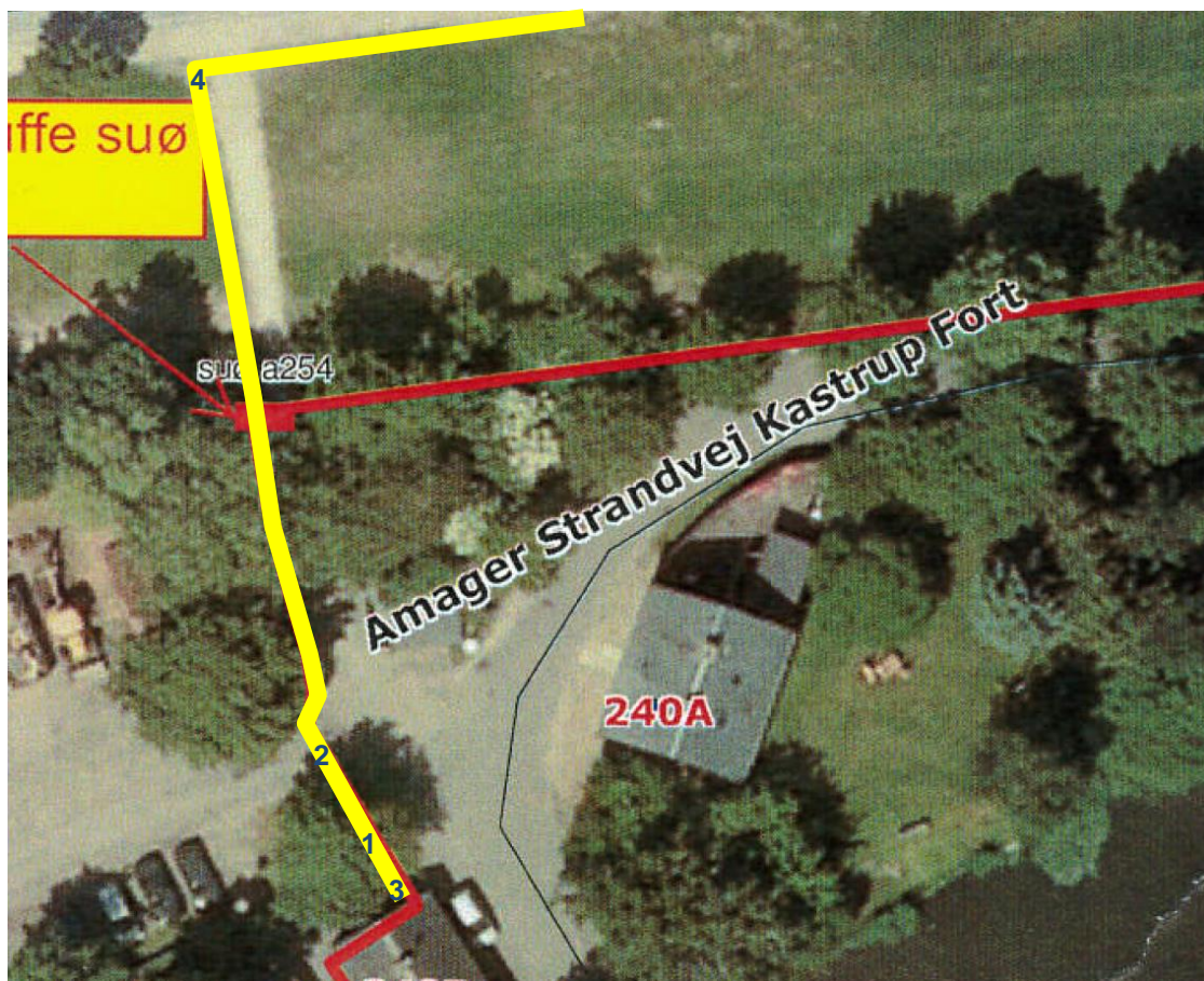
Fig. 2. Markering af planlagte tracéforløb (rød streg), udførte/underborede tracé (gul streg) og placering af lokaliserings- og borehul 1-4 (blå tal)
